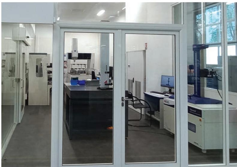
↑ Le local comprend une troisième salle qui accueille entre autres d'autres moyens de mesure, à savoir une MMT Prismo de Zeiss, un instrument de mesure 2D vertical V9 de Trimos et un poste de mesure de circularité, de cylindricité, de battement Talyrond 585H de Taylor Hobson. Toutes les salles du local sont entièrement vitrées pour permettre notamment à Microrectif et Zeiss de mettre en avant la machine Xenos auprès de visiteurs et de clients potentiels.
